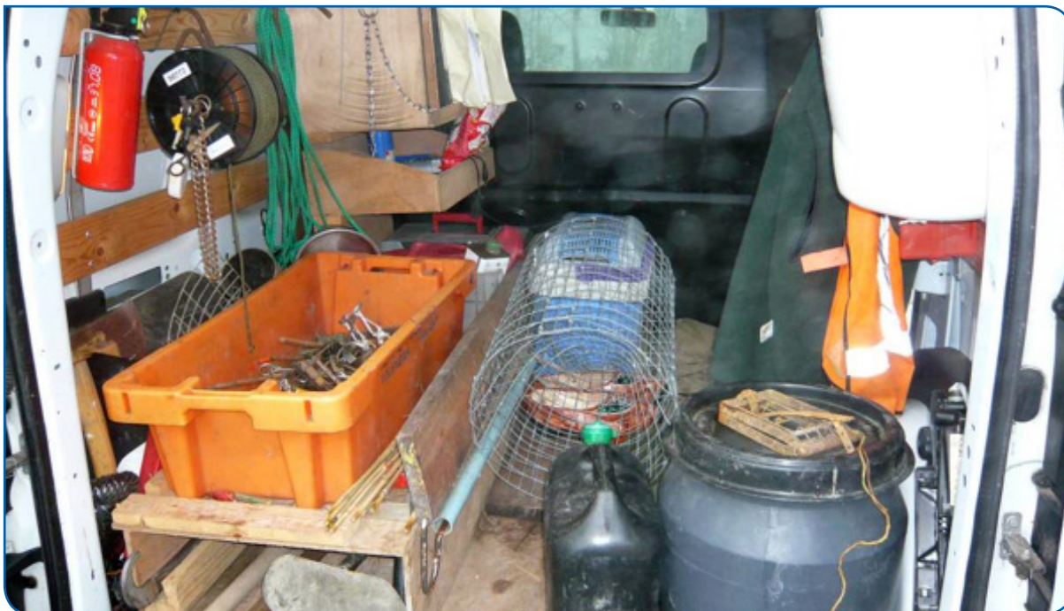
FOTO 3-4 GESCEIDEN SCHOON EN VUILE GEDEELTE. HET SCHONE GEDEELTE IS DE BESTUURERSRUIMTE. HET VUILE GEDEELTE IS DE GEHELE LAADRUIJTE. DE RUIJTEN WORDEN GESCEIDEN DOOR DE WAND. RECHTSVOOR IS DE KADAVERTON WEERGEGEVEN.
