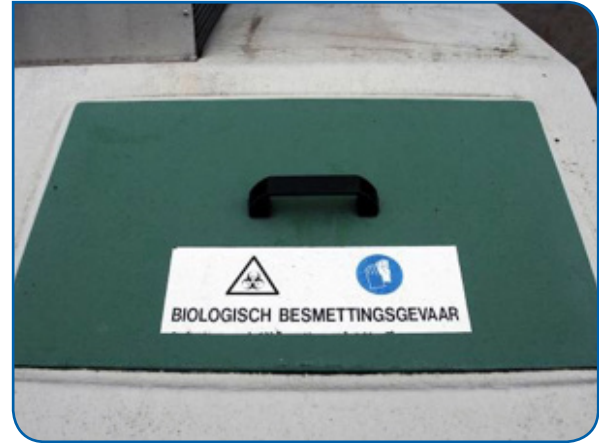
FOTO 3-5 KOELING WAAR KADAVERS TIJDELIJK WORDEN OPGESLAGEN. DE KOELING IS VOORZIEN VAN GEVAARSYMBOLLEN EN EEN GEBODSPICTOGRAM VOOR HET DRAGEN VAN HANDSCHOENEN.
