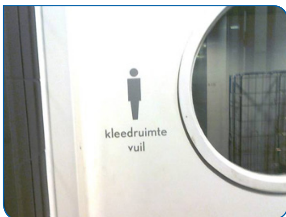
FOTO 2-1 SCHEIDING VAN VUILE EN SCHONE KLEDINGRUIMTE BIJ EEN WATERZUIVERING. SCHEIDING IS DUIDELIJK GEMAAKT DOOR PICTOGRAM EN ANDERE KLEUR DEUR.
